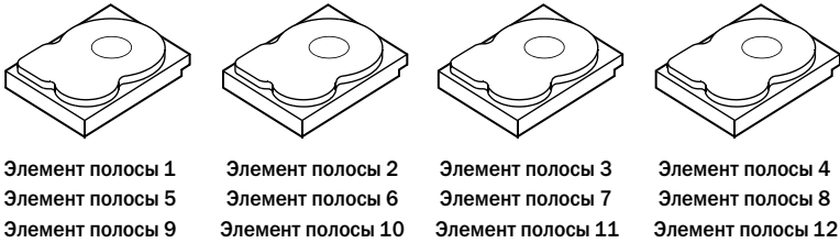
Рисунок 1-1. Пример расщепления дисков (RAID 0)
